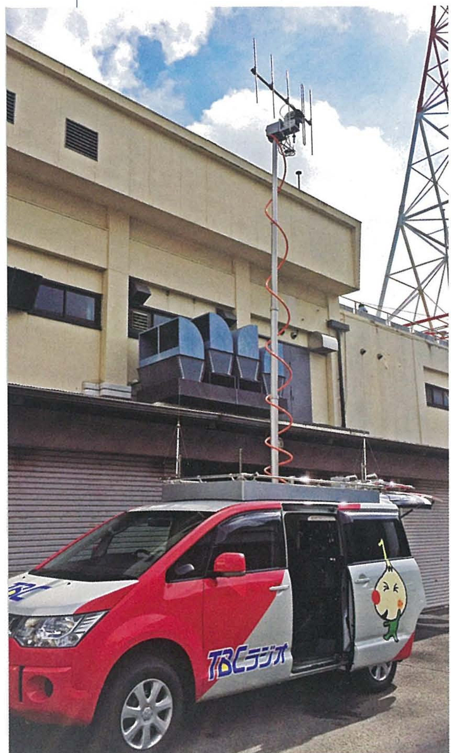
伸縮ポールシステムの使用例。中継車の屋根から伸びる送信アンテナに使われている（同社提供）
