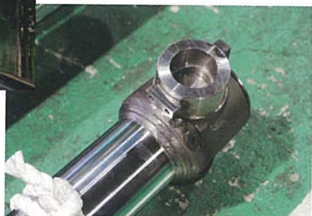
油圧シリンダーの溶接工程
