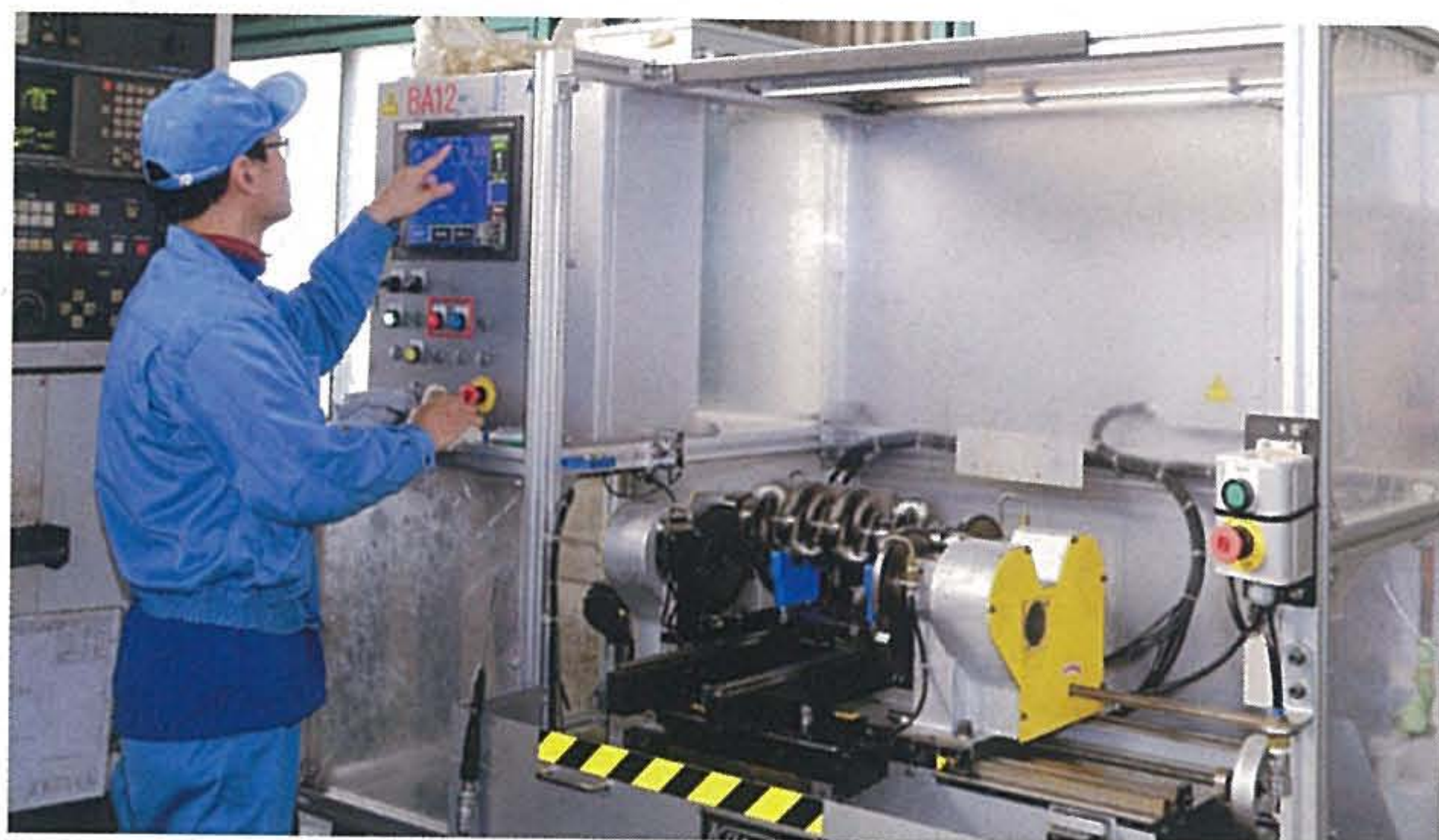
高速回転検査。実際の使用時と同じ高速で回転させ、軸のブレを修正する
