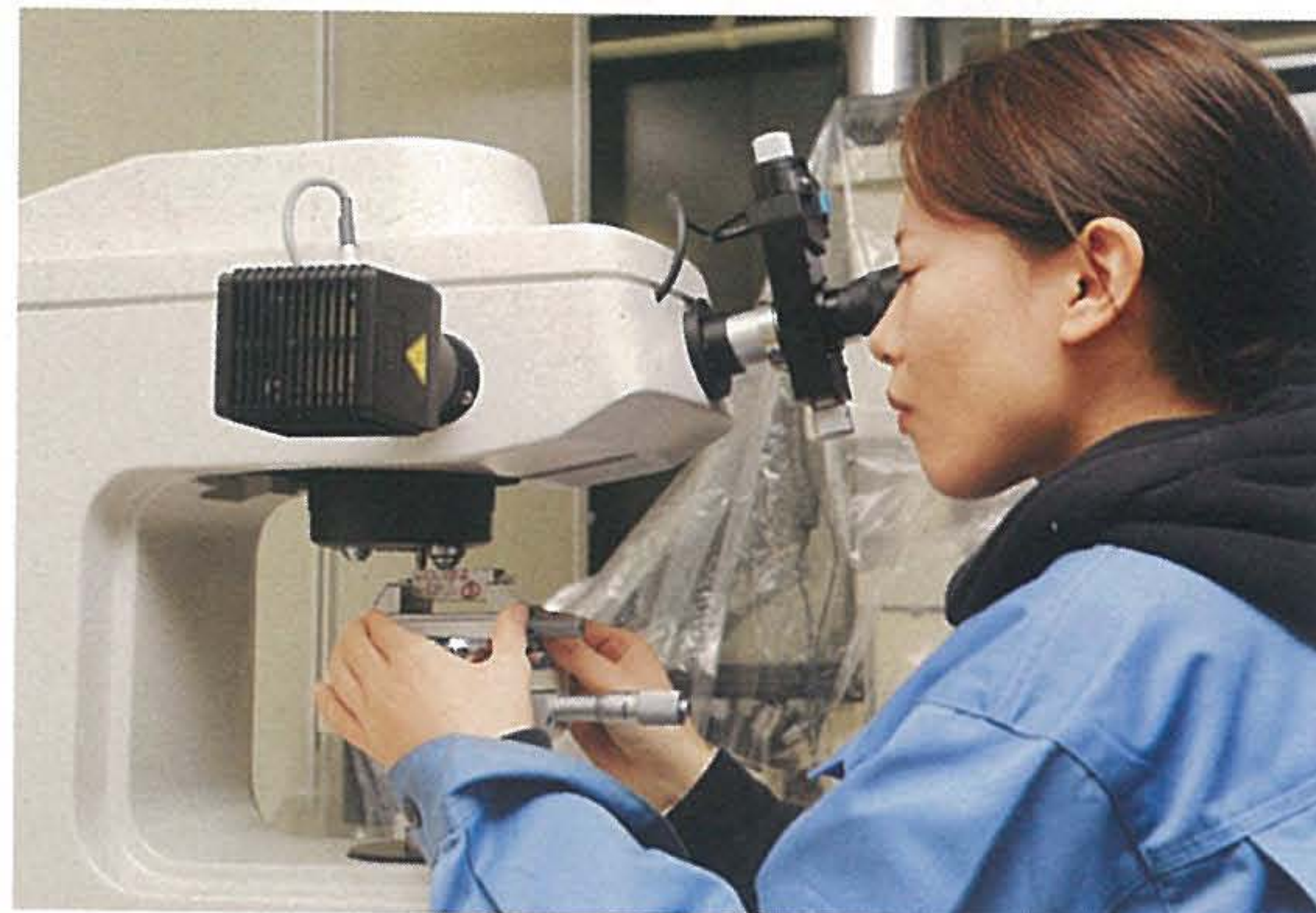
熱処理後の検査。資格保持者(2級金属熱処理技能士)による検査・認証を行う
