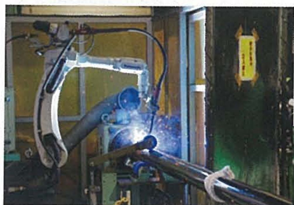
油圧シリンダーの溶接工程
