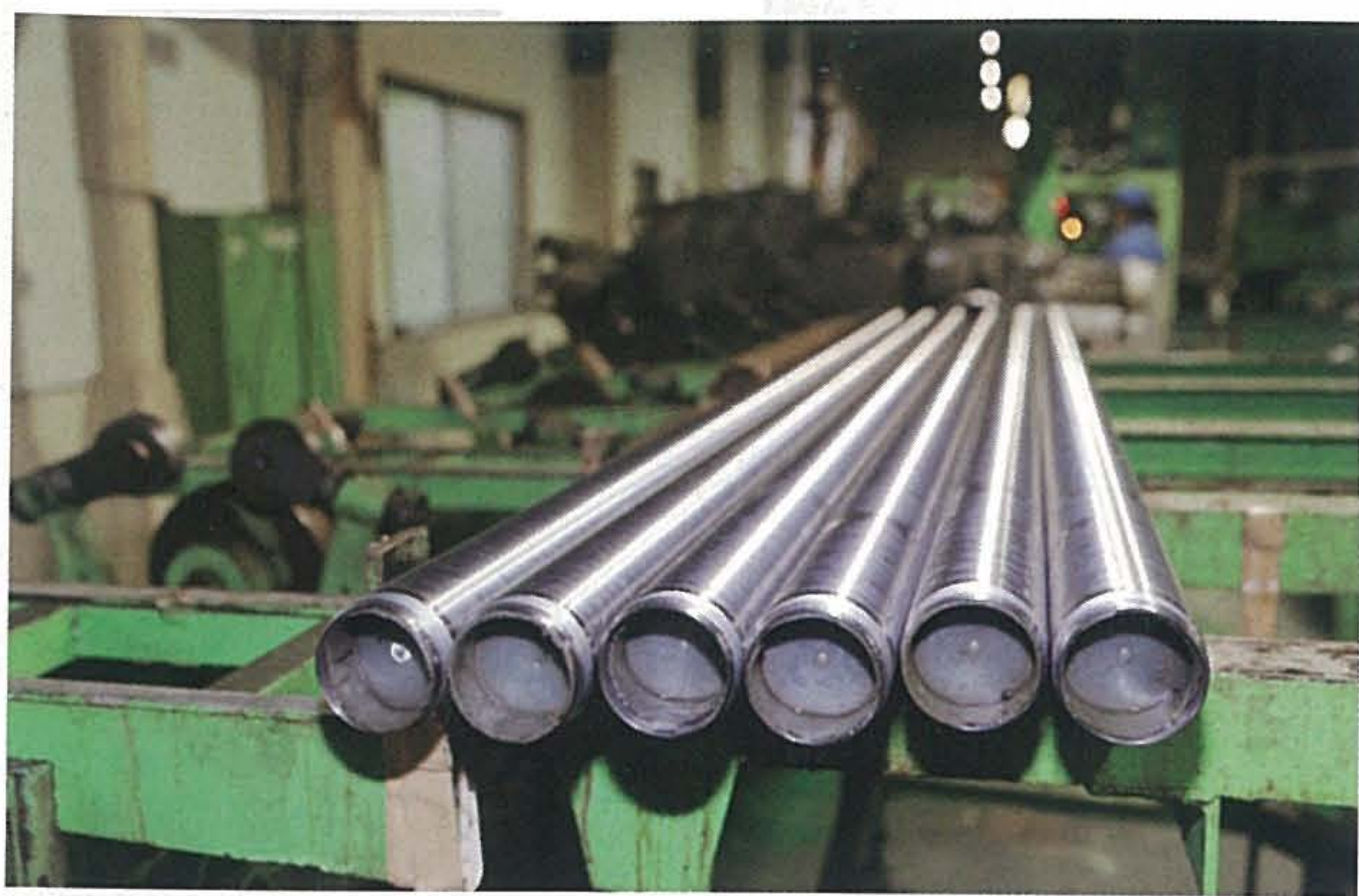
油圧シリンダー部品。内側の切削工程
